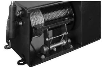
Alle Muttern der Befestigungsbolzen in gleichem Maße festdrehen und sichern.
